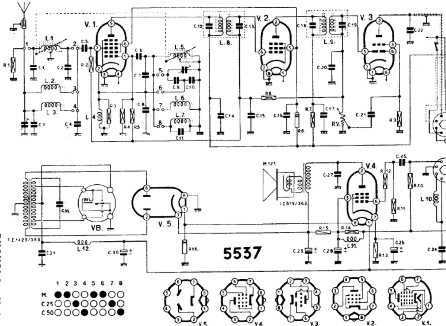
FIMI S. A. - PHONOLA - Mod. 5537 Autoradio. Onde medie da 187,5 a 571 m, due bande allargate, a 49 e 25 m. Media frequenza 470 KHz. Assorbimento: 2,9 A e 12 V. Potenza indistorta 3,3 W.
